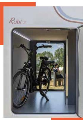
SOUTES GARAGES GRANDS VOLUMES ET SUREQUIPÉS : Toutes nos soutes sont tapissées de moquette, éclairées d'un bandeau LED, chauffées et équipées de prises 12 V et 220 V, centralisation des vannes de vidanges.
