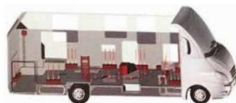
le plancher est chauffant et une vanne permet d'isoler le circuit de la chambre, celui du séjour et celui du plancher. Le sèche serviette chauffant ALDE est intégré dans le cabinet de toilettes.
