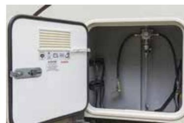
Coffre à Gaz 2 bouteilles 13kg avec détecteur de pression de gaz + capteurs de collision et Duo Control CS\* (inverseur de gaz automatique). Indicateur de niveau de gaz à distance Truma Duo C\*
