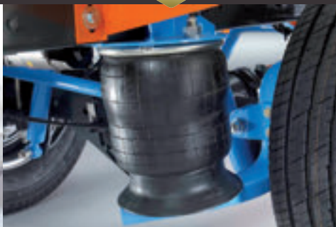
Suspensions VB Air entièrement pneumatique avant / arrière*
